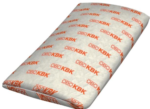
Огнестойкая подушка из мелкоячеистой, плотной и механически прочной стеклоткани со специальным наполнителем. Без минеральных волокон, стойкость к атмосферной коррозии и воздействию влаги. Неограниченный срок хранения в сухих и теплых помещениях.
