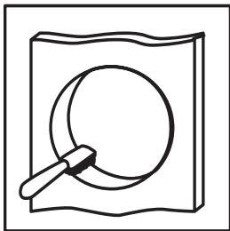
Перед началом выполнения работ по герметизации проходки необходимо тщательно очистить проходку от пыли при помощи щётки или продуть струёй сжатого воздуха. При наличии в объеме проходки любых материалов, не относящихся к строительной конструкции, их необходимо полностью удалить.
