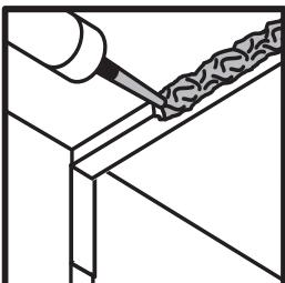
Зазор с каждой стороны деформационного шва заполнить огнезащитным силиконовым герметиком FBA-SP толщиной, в зависимости от выбранного решения, не менее 6 мм.
