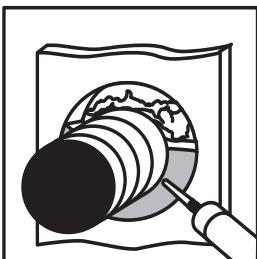
Зазор с каждой стороны проходки заполнить огнезащитным силиконовым герметиком FBA-SP, толщиной не менее 6 мм в зависимости от выбранного решения.
