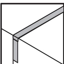
Работы по герметизации деформационного шва завершены. Не подвергать механическому воздействию до полного схватывания, не менее 24 часов.
