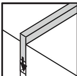
В деформационный шов шириной не более 200 мм, в зависимости от толщины строительной конструкции и выбранного решения, заложить теплоизоляционный материал – минеральную вату (типа НГ по ГОСТ 30244-94) плотностью не менее 110 кг/м<sup>3</sup>.
