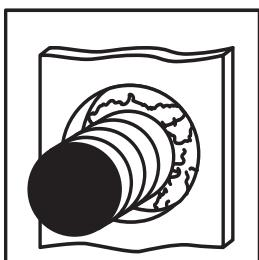
В свободное пространство проходки заложить теплоизоляционный материал – минеральная вата (типа НГ по ГОСТ 30244-94) плотностью не менее 110 кг/м<sup>3</sup>. При укладке теплоизоляционного материала предусмотреть зазор (пространство) для нанесения герметика огнезащитного силиконового FBA-SP с каждой стороны проходки.
