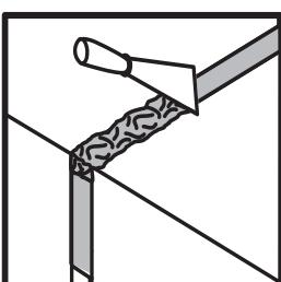
При необходимости излишки герметика разгладить (удалить) влажным шпателем.
