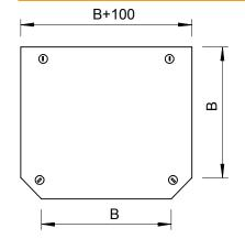
Ширина 100,00 мм Высота боковой стенки 35,00 мм Размер В 100,00 мм Размер Н 15,00 мм 4,00 шт. Количество шпингалетов Поворотный фиксатор Вид крепления Толщина материала 1,00 мм Предусмотрено для листового  $\checkmark$ кабельного лотка Подходит для кабельных  $\checkmark$ лестничных лотков Нержавеющая сталь, протравленная
