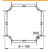
100,00 мм Ширина Высота боковой стенки 60,00 мм Размер R 50,00 мм Размеры 250 х 250 х 60 мм Предназначено для поддержания функций Толщина борта 1,25 мм Толщина материала пластины 1,00 мм Нержавеющая сталь, протравленная Исполнение для больших расстояний
