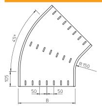
600,00 мм Ширина Высота боковой стенки 60,00 мм Размер В 600,00 мм Размер R 150,00 мм 45° Изгиб (угол) Конструкция соединителей Без соединителя Предназначено для поддержания функций Монтажные отверстия в основании Схема расположения отверстий NATO Изменение направления горизонтальный Нержавеющая сталь, протравленная Боковая перфорация Исполнение для больших расстояний
