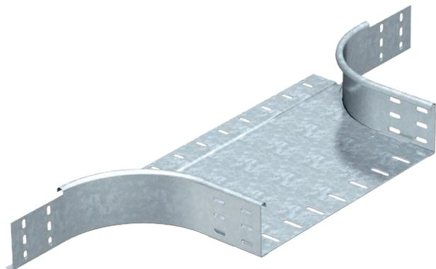
T-образное/крестовое соединение для горизонтального и вертикального монтажа. Для всех типов листовых кабельных лотков, высота боковой стенки которых составляет 85 мм.
