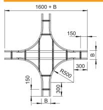
200,00 мм Ширина Высота боковой стенки 110,00 мм Размер В 200,00 мм Размер R 500,00 мм Профиль неперфорированный Конструкция перекладин Конструкция бокового Плоский профиль профиля 2,00 мм Толщина борта Предназначено для поддержания функций Нержавеющая сталь, протравленная Исполнение для больших  $\checkmark$
