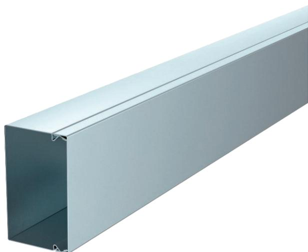
Кабельный короб с перфорацией дна. Уравнивание потенциалов между крышкой и основанием кабельного короба осуществляется без дополнительных средств. Кабельный короб тип LKM 60100FS соответствует требованиям стандарта DIN 4102 часть 12. Возможно использование при прокладке огнестойких кабельных трасс.
