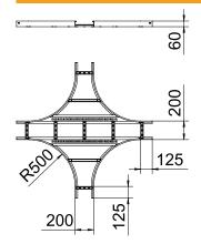
Ширина 200,00 мм Высота 60,00 мм Высота боковой стенки 60,00 мм 200,00 мм Размер В Размер R 500,00 мм Конструкция перекладин Профиль неперфорированный Конструкция бокового Плоский профиль профиля Толщина борта 1,50 мм Предназначено для поддержания функций Нержавеющая сталь, протравленная Исполнение для больших расстояний
