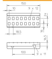
64,00 мм Высота Высота боковой стенки 60,00 мм Размеры 64х150 мм Конструкция Продольный соединитель Толщина материала 1,50 мм Предусмотрено для листового кабельного лотка Подходит для проволочного лотка Подходит для кабельных  $\checkmark$ лестничных лотков Горизонтальный поворотный соединитель Вертикальный поворотный соединитель Нержавеющая сталь, протравленная Вид соединения Болтовой соединитель
