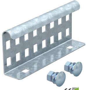
Продольный соединитель в качестве внешнего крепления для фиксации кабельных лотков лестничного типа и фасонных деталей с высотой боковой стенки 60 мм и сквозной перфорацией стенки.
