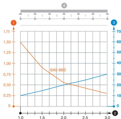
Диаграмма нагрузки на кабельный лоток типа LKSU 60
