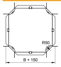
300,00 мм Ширина Высота боковой стенки 60,00 мм Размер R 50,00 мм Размеры 450 х 450 х 60 мм Предназначено для поддержания функций 1,25 мм Толщина борта Толщина материала пластины 1,00 мм Нержавеющая сталь, протравленная Исполнение для больших расстояний
