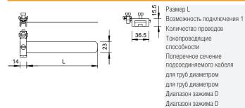
395,00 мм макс. 2 провода 2,5 - 25 мм<sup>2</sup> 2,00 N/50 кА 2,50 - 25,00 мм<sup>2</sup> 17,20 - 114,00 мм
