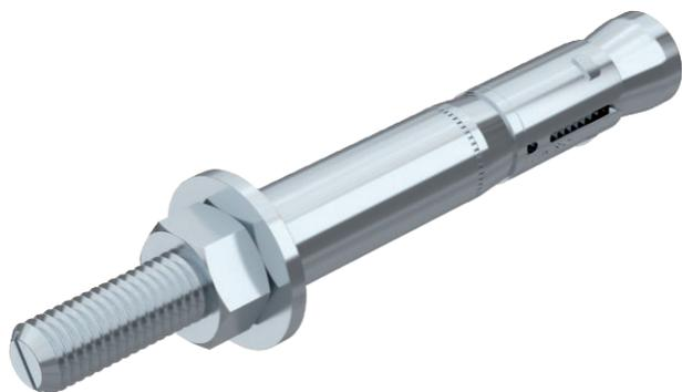
Усиленный анкерный болт SZ для высоких нагрузок. Имеет специальную укороченную анкерную гильзу с тремя распорками и удлиненную резьбу, пластмассовое прессовочное кольцо обеспечивает прочное крепление деталей.
