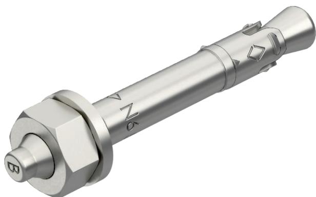
Анкерный болт N применяется для универсального крепления не несущих конструкций в растянутом или сжатом бетоне, он обеспечивает прочную фиксацию при простом монтаже. Для монтажа анкерного болта достаточно установить его в просверленное отверстие. Закручивать анкерный болт при этом не требуется. При воздействии нагрузки анкерный болт автоматически раскрывается и надежно фиксируется в просверленном отверстии.
