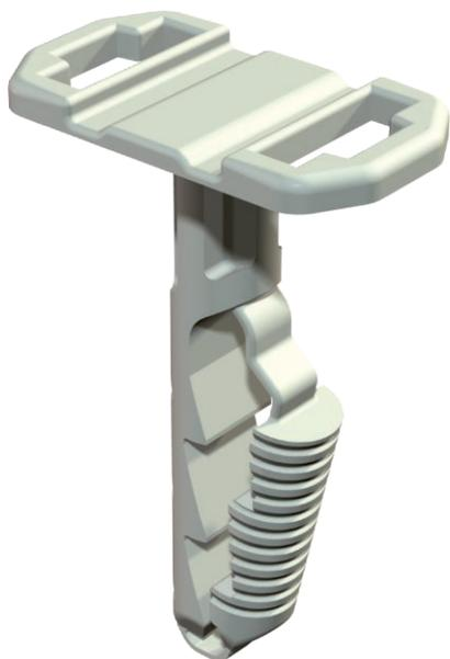
Со вставным дюбелем применяются кабельные стяжки типов 550 или 555 шириной до 9 мм, что позволяет устанавливать множество различных кабелей и труб. Дюбель подходит для применения в бетоне, силикатном или цельном кирпиче. Использование в газобетонной стене возможно, все же необходимо рассчитать уменьшение несущей способности.
