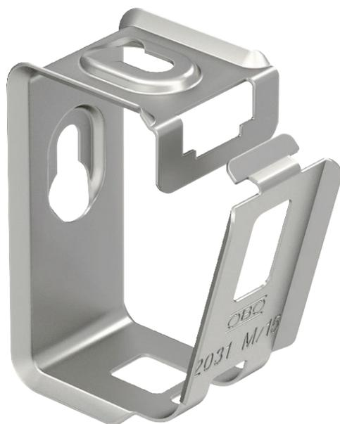
Групповое крепление из металла высокой механической прочности, в том числе при пожаре. Предусмотрено для монтажа над огнестойкими потолками. Допускается применение в качестве специальной конструкции при прокладке кабельных трасс повышенной живучести в соответствии с DIN 4102 часть 12. Для настенного и потолочного монтажа. Открывается без применения инструмента.
