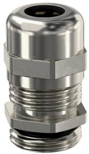
Жесткий кабельный ввод с метрической соединительной резьбой по IEC 423 в конструкции с глухой гайкой для высоких требований герметичности Разгрузка от натяжения, защита от прокручивания и герметичность по всей области зажима. Уплотнительное кольцо из неопрена. Зажим из полиамида. С заранее установленным уплотнительным кольцом на соединительной резьбе, проверено VDE согласно DIN EN 50262, степень защиты IP68 при 5
