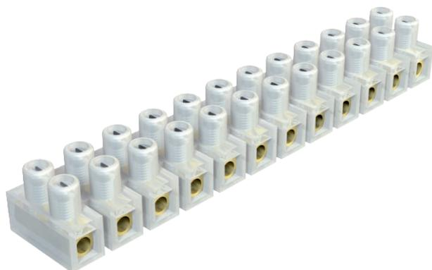
Клеммные колодки из латуни, никелированные, винты из стали, гальванически оцинкованные с синим хромированием, 12-полюсные, с отсоединяемыми колодками, которые можно использовать в качестве отдельных клемм.
