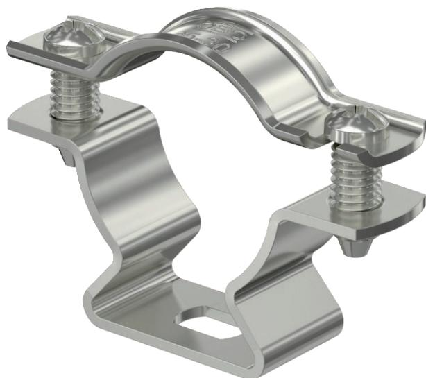
Дистанционная скоба для монтажа труб и кабелей на стене, потолке и на полу. С самоблокирующейся верхней частью. Крепление через продольное отверстие. Начиная с размера 20, скобы можно монтировать с помощью устройства для забивания гвоздей и прибора для установки болтов.
