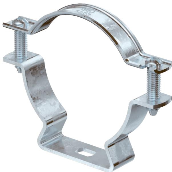
Дистанционная скоба для монтажа труб и кабелей на стене, потолке и на полу. С самоблокирующейся верхней частью. Крепление через продольное отверстие. Начиная с размера 20, скобы можно монтировать с помощью устройства для забивания гвоздей и прибора для установки болтов.
