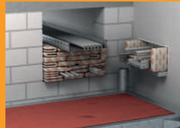
Отверстие заполняется подушками без шпатлевки или окраски.
